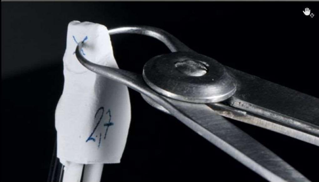
**06** Bestimmung der Stärke des Stumpfes ohne aufgetragene Keramik. Die Stärke der Veneers wird mithilfe der gesetzten Kreuze kontrolliert. Eine kleine palatinal angebrachte Kuhle ermöglicht es, das Verhältnis der Ausgangsstärke zum geschichteten Veneer im Blick zu behalten.
